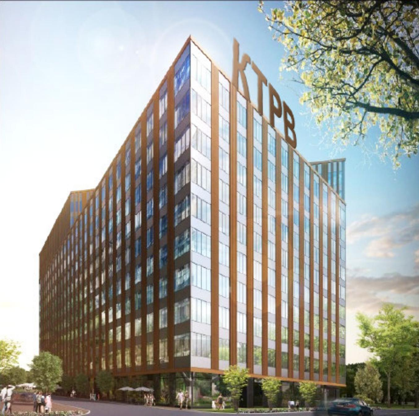
Фасад здания оформлен в классическом стиле. Наружные стены в пределах 1-го этажа облицованы натуральным камнем – гранит, со 2-го этажа по 12-й вентилируемая система из керамических панелей терракотового цвета. Двухкамерные стеклопакеты с мультифункциональным стеклом.
